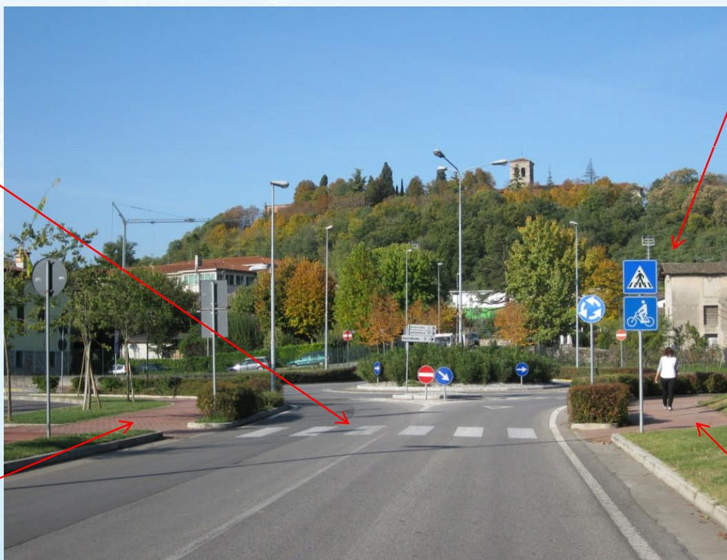
Per migliorare la percezione di un attraversamento ciclopedonale da parte degli utenti della strada, si può aggiungere il pannello verticale di attraversamento ciclabile.
