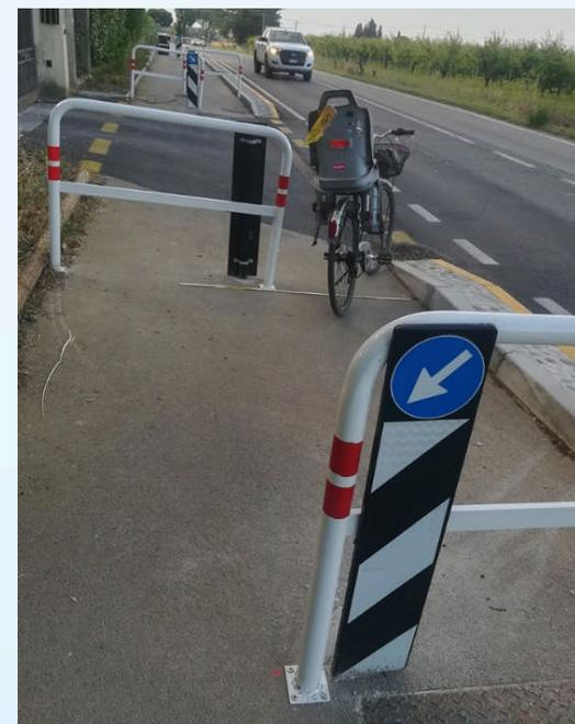
I dissuasori di sosta servono per impedire la sosta di veicoli in aree o zone determinate. Sono talvolta impiegati anche sui percorsi ciclabili causando difficoltà ai ciclisti in transito, specie se dotati di borse da viaggio o rimorchi.
