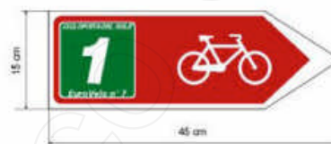
Segnali di direzione semplice con numerazione itinerario
