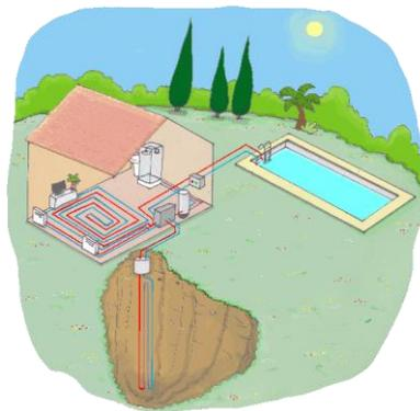
*Pompa di calore a collettori verticali*
