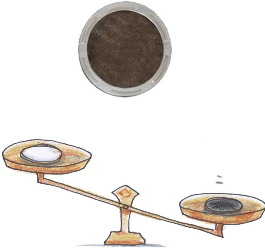
L'inquinamento da polveri fini si misura grazie ad una speciale bilancia elettronica che permette di misurare la differenza di peso tra un filtro nuovo e un filtro carico di polveri, indicando in questo modo la quantità di particelle.
