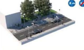
**Pista ciclabile MONODIREZIONALE** con tipo di separazione a scosta in rapporto del traffico veicolare ordinario.
