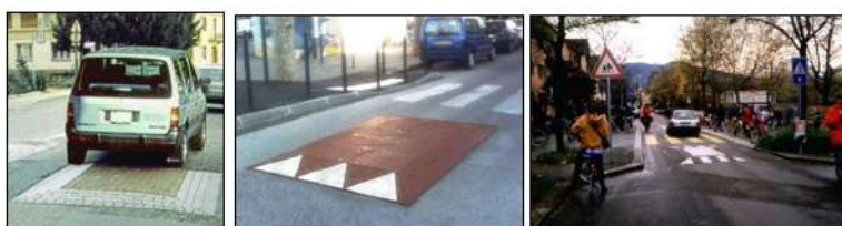
Esempi di cuscino berlinese: il dispositivo di moderazione permette il passaggio in piano dei veicoli a due ruote.
