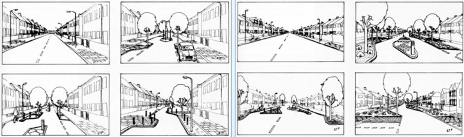
Le chicane sono realizzate per **indurre i veicoli a ridurre la velocità** su tratti di strada che, data la loro lunghezza e rettilineità, possono consentire accelerazioni eccessive. Il rallentamento viene determinato sia dalla manovra di correzione di traiettoria imposta al veicolo, sia dalla sensazione di “strada chiusa” che la chicane dà agli automobilisti quando viene vista da lontano.
