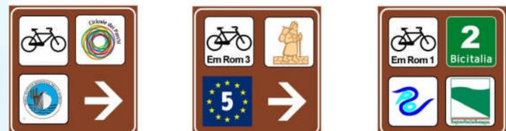
**Fig 3:** Segnalini di conferma **composti** per viabilità riservata (grande 40 cm di lato e piccolo 25 cm: figura II 261 art 129 DPR 495/92)
