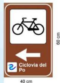
**Fig 3:** Cartello per avviare a itinerario ciclopedonale generico ottenuto da modifiche delle figure 360 - 363 art 136 DPR 495/92
