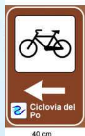
Fig 3: Cartello per avviare a itinerario ciclopedonale generico ottenuto da modifiche delle figure 360 - 363 art 136 DPR 495/92
