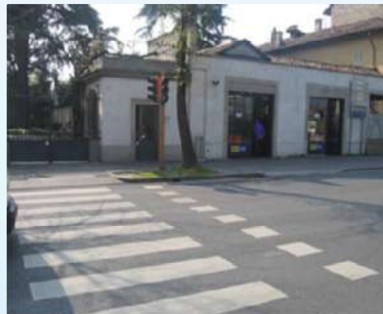
Soluzione con attraversamenti affiancati (assenza di una fila di quadrati)
