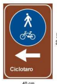
Fig 4: Cartello avviare a itinerario ciclopedonale su viabilità riservata ottenuto da modifiche delle figure 360 - 363 art 136 DPR 495/92
